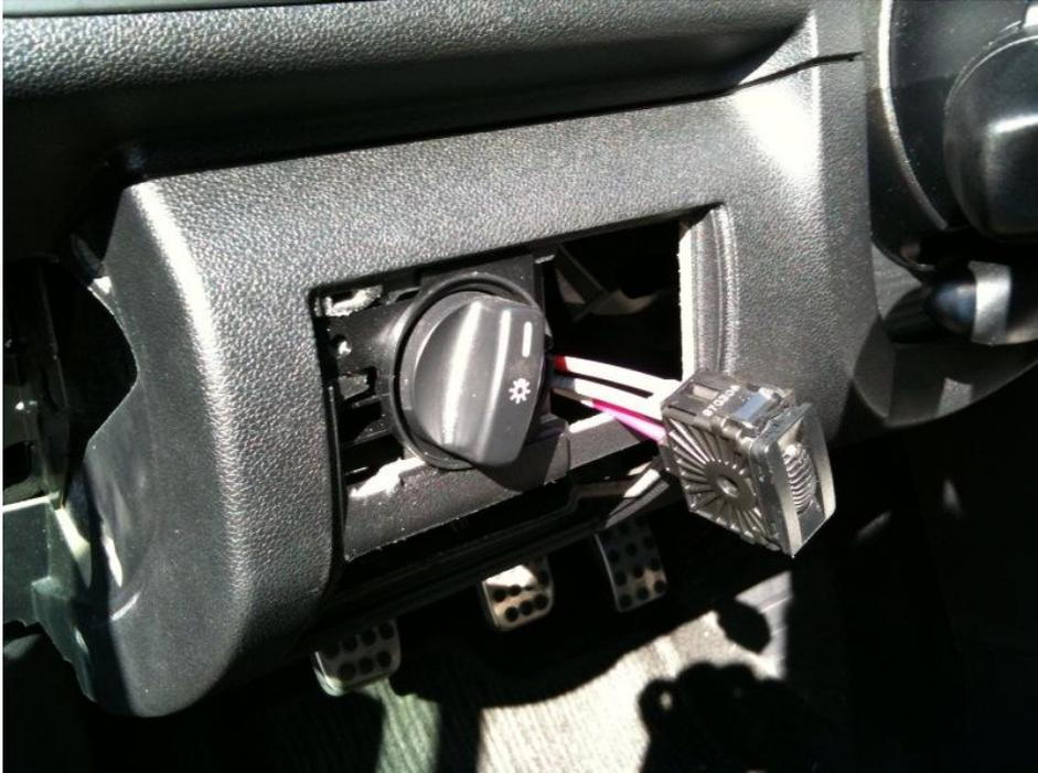
Stattdessen wird hier der Taster für die Scheinwerferreinigung montiert. Dann wird das Kombiinstrument ausgebaut (Ausziehhaken verwenden), dahinter kommt dieser Stecker zum Vorschein. Und für alle, die sich schon gefragt haben, wie es hinter dem KI aussieht: Mehr ist dort wirklich nicht, ein Stecker und jede Menge Dämmmaterial:
