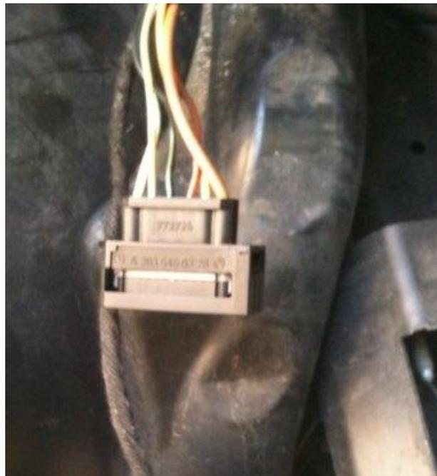
Zum Schluss noch eine Verbindungsleitung zwischen den beiden Scheinwerfern, die jeweils auf dem 3-poligen Stecker endet, an dem aber auch die Zuleitung vom Sicherungskasten und der Draht vom Diagnosestecker angeschlossen wird.
