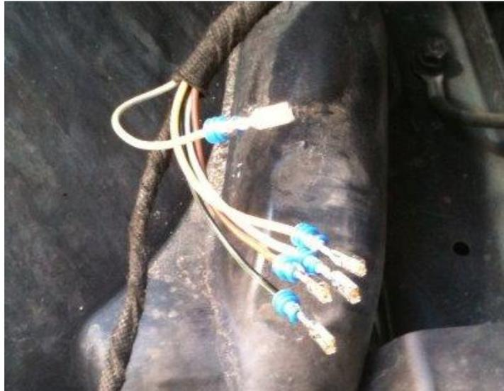
Pro Scheinwerfer wird ein zusätzlicher Massedraht (Anschlusspunkt jeweils im Radkasten rechts und links) benötigt, dann wird das 6-polige Gehäuse montiert:
