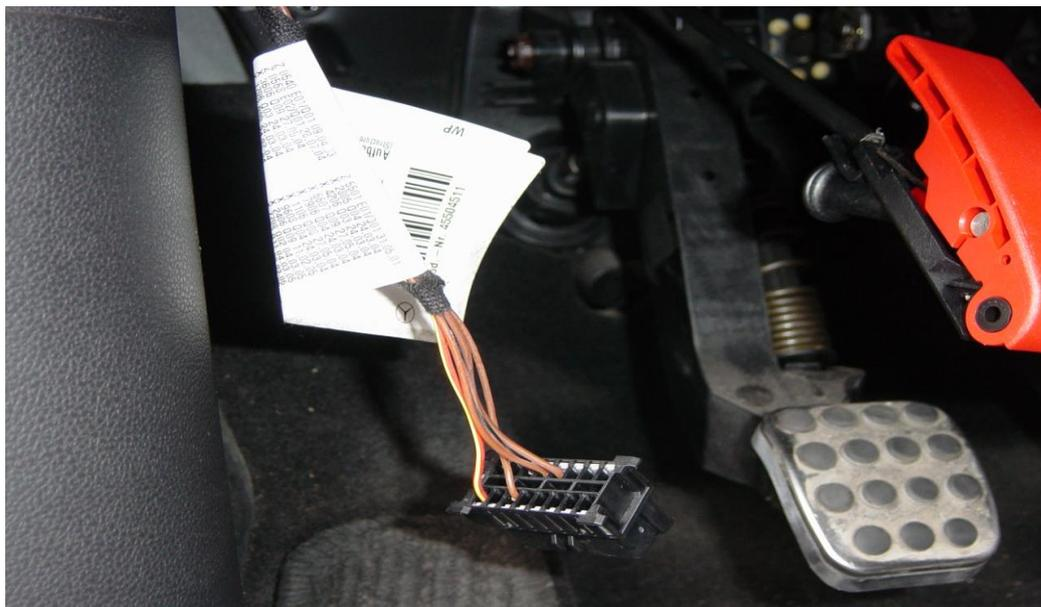
Dann wird der Lichtschalter mit samt dem Ablagefach demontiert, hierfür Montagekeil verwenden, um keine Teile zu beschädigen. Hier sieht man noch den Drehschalter der pneumatischen LWR:
